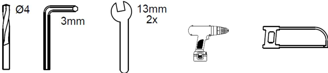
Nr.4 Bohrer Innensechskantschlüssel Schraubenschlüssel Akku-Bohrer Handsäge
