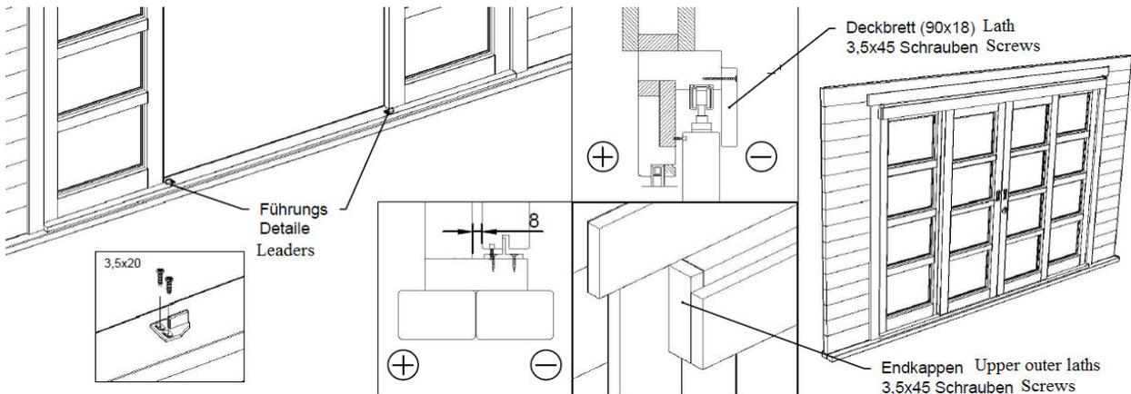
Bringen Sie schließlich Deckbretter an, um die Metallprofile und das Rollsystem abzudecken und die Tür winddicht zu machen.
