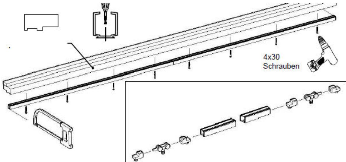
Bohren Sie die Löcher in beiden Metallprofilen vor, wobei der obere Teil des Bohrlochs breiter sein muss, damit die Schrauben komplett ohne Überstand angebracht werden können. Überstehende Schrauben verhindern ein freies Rollen der Türen!
