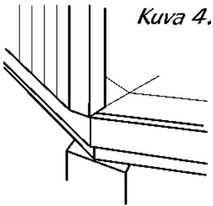
Heben Sie die erste Wand so auf den Sockel, dass die Wandpaneele außerhalb des Sockelbodens sind (Abb. 4) und die Ecken mit den Bodenverbindungen überlappen. Stützen Sie das erste Element ab und bringen Sie das nächste Element daneben an. Achten Sie darauf, dass es richtig aufliegt, und verschrauben Sie es mit dem ersten Element von außen (Abb. 5), aber noch nicht mit dem Boden.
